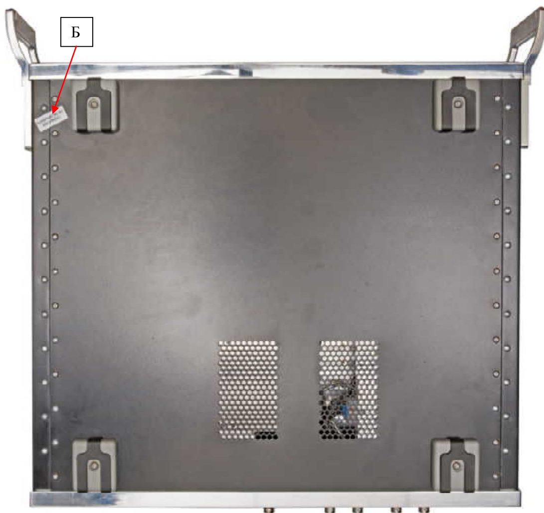
Рисунок 2 - Вид нижней панели и схема пломбировки от несанкционированного доступа (Б)
